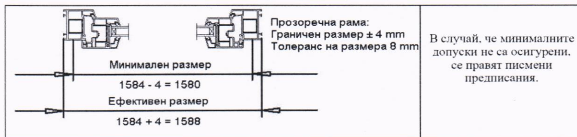
Фиг. 4. Съгласуване – прозоречна рама
