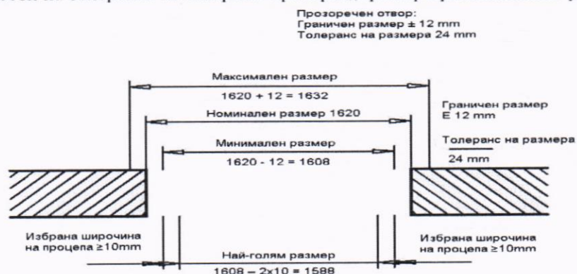
Фиг. 3. Стойности на толеранса за отваряем прозорец (пример при номинален размер 1620 mm)
